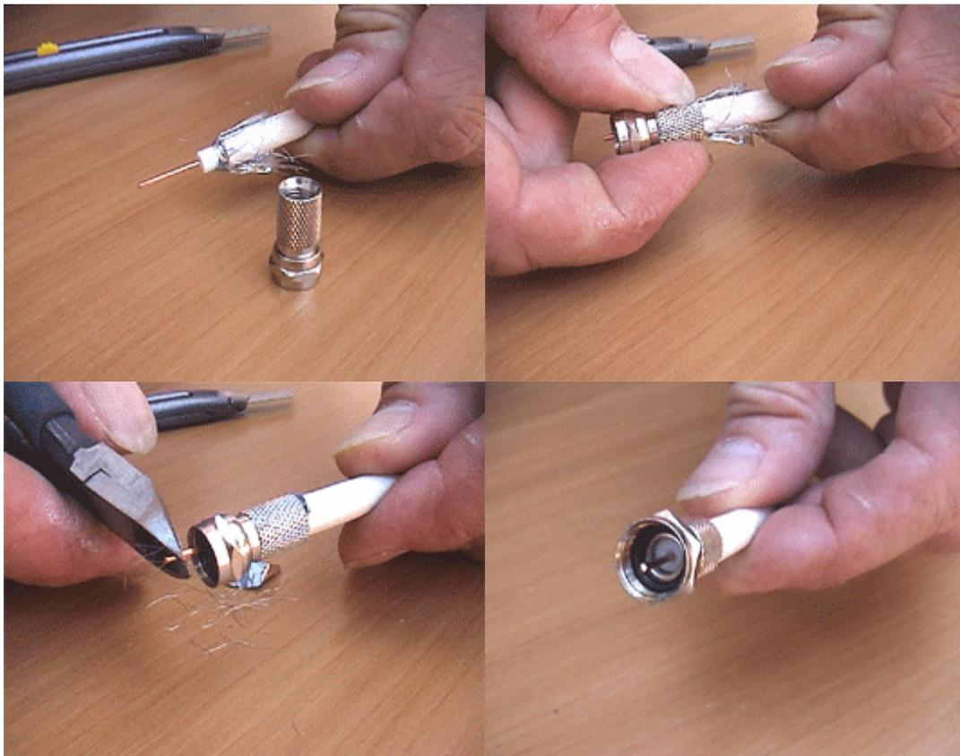
Dénuder la gaine intérieure à environ 3mm du blindage en prenant soin de ne pas endommager le fil de cuivre situé au centre du câble coaxial, appelé également l'âme
